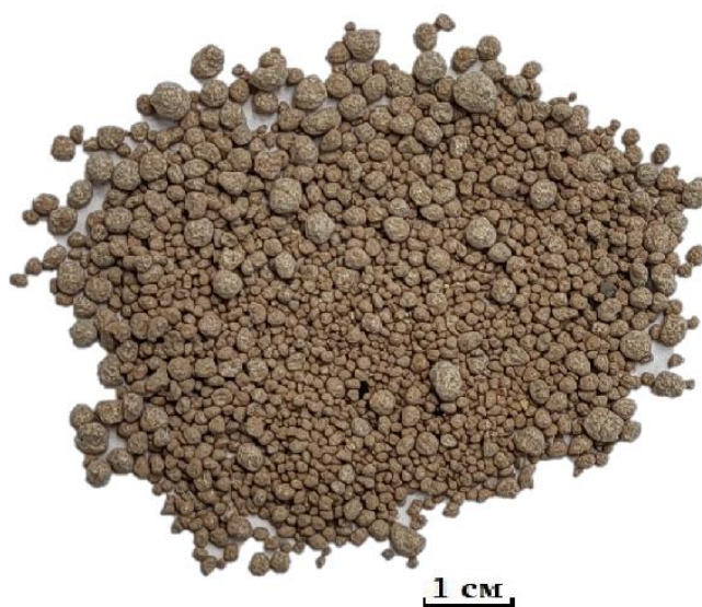
Рисунок 4.17 – Гранулы после формования в тарельчатом смесителе-грануляторе марки ТЛ-020
