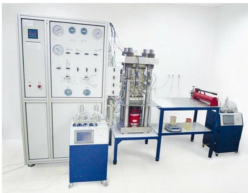
Рисунок 5.8 – Установка для измерения проводимости пропантовой упаковки марки ПИК-API-RP-61
