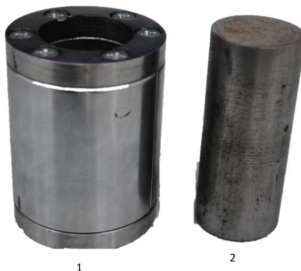
Рисунок 4.22 – Цилиндр для раздавливания: 1 – цилиндр; 2 – пуансон
