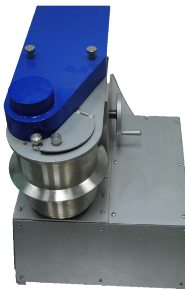
Рисунок 4.16 – Смеситель-гранулятор тарельчатого типа марки ТЛ-020
