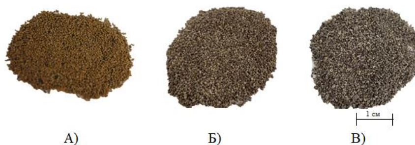
Рисунок 4.19 – Гранулы алюмосиликатных пропантов на основе буровых шламов обожженные при: А) – режим № 1, Б) – режим № 2, В) – режим № 3
