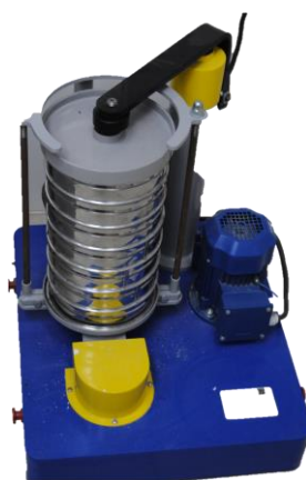
Рисунок 4.21 – Ударный ситовой анализатор марки АС-200У
