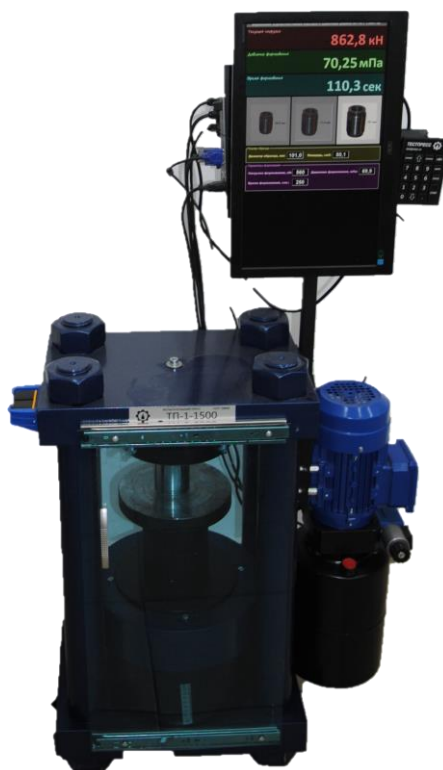
Рисунок 4.23 – Гидравлический пресс марки ТП 1-1500
